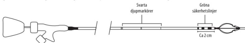
**Varning:** Om skärbladen och centreringsringarna inte innesluts i skyddshöljet innan instrumentet dras ut från venen kan skador uppstå.
