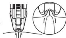
LA IMPOSIBILIDAD DE APRETAR LAS PALANZAS COMPLETAMENTE PUEDE CAUSAR QUE SE DEFORMEN LAS PINZAS Y PUEDEN APARECER HEMORRAGIAS O DERRAMES.
